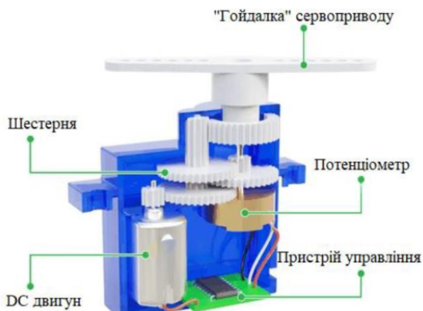
Рис. 3.16. Складові сервоприводу
