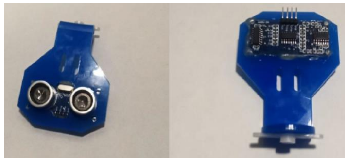
Рис. 3.10. Ультразвуковий датчик, закріплений на тримачі для подальшого закріплення на серводвигуні
