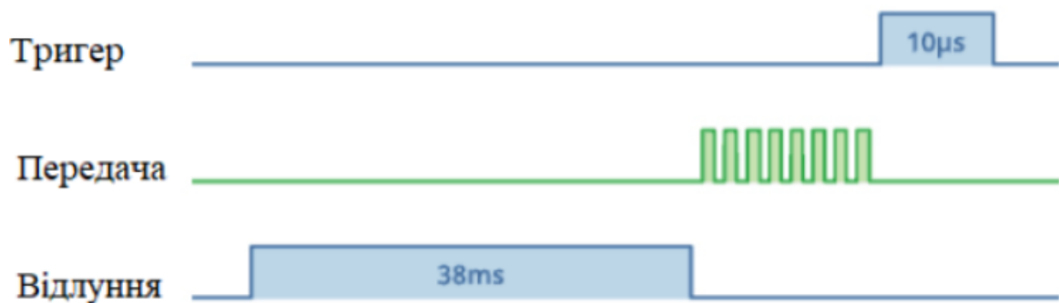
Рис. 3.11. Принцип роботи сигналу за відсутності перешкод
