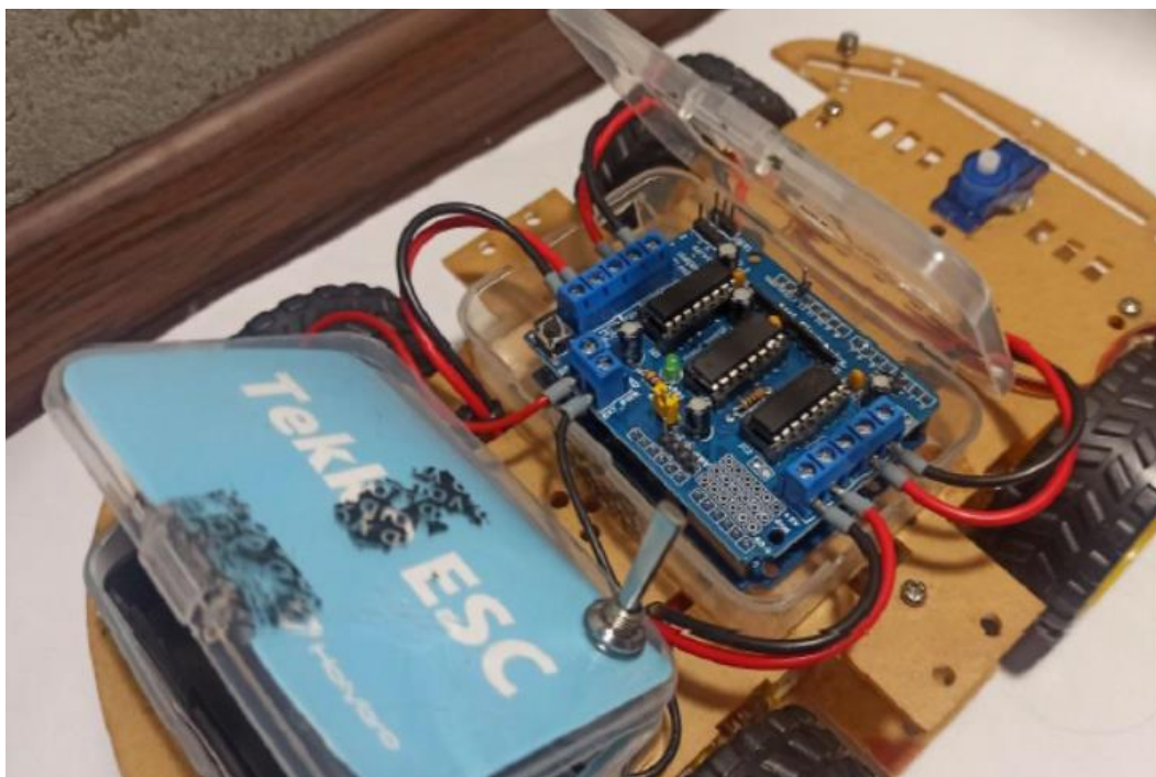
Рис. 3.26. З'єднання шилда з двигунами та системою живлення
